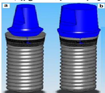
شکل ۲: الف) مدل ایمپلنت Laser-Lok Internal دارای پلتفرم سوئیچینگ، ب) مدل نمونه شاهد (ایمپلنت Laser-Lok Internal با اباتمنت هم اندازه)
