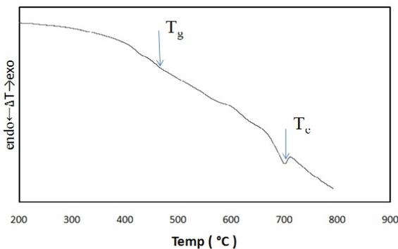
شکل ۱- منحنی DTA شیشه اکسی فلورایدی آلاییده به Nd<sup>3+</sup>، دمای گذار (T<sub>g</sub>) و تبلور (T<sub>c</sub>) با فلش مشخص شده است.
