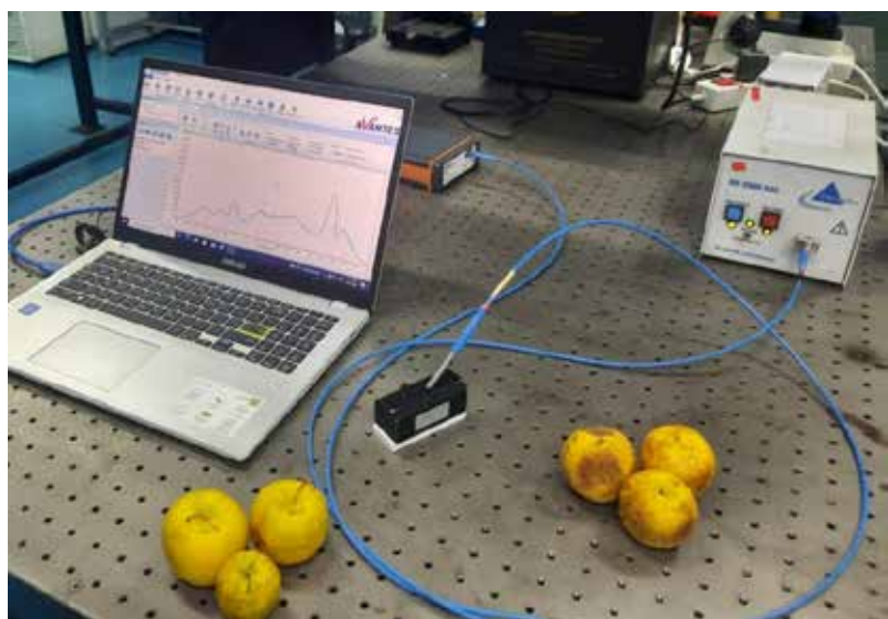
شکل ۱- چیدمان آزمایشگاهی طیف‌سنجی بازتابی پخشی
