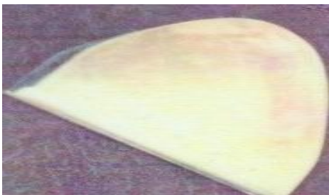
شکل ۶: صفحه آلومینیومی خازن به شکل سهمی
