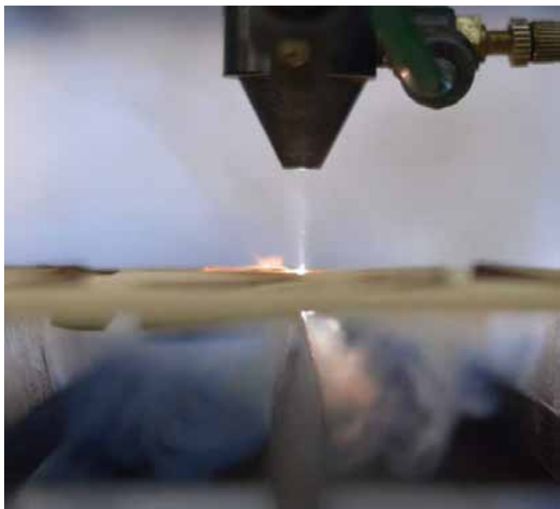
شکل ۴: تولید بخار فلزی به هنگام برش لیزری
