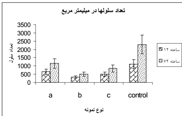
شکل ۵- تعداد سلول‌ها ( $m^{-2}$ ) بعد از ۱۲ و ۷۲ ساعت  $\pm SD$  بر روی سیلیکون خام (a) و پلی‌اکریلیک اسید پیوند شده بر سیلیکون با شرایط پیوند: غلظت ۳۰٪- دما: ۶۵°C - زمان پیوند ۴ ساعت و فرکانس و پالس لیزری: ۱ و چگالی انرژی لیزر: (b)  $1/25 J/cm^2$  و (c)  $3 J/cm^2$
