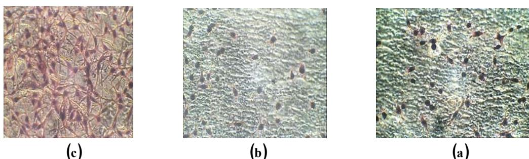
شکل ۸- کشت سلولی بعد از ۷۲ ساعت بر روی سیلیکون خام (a) و پلی‌اکریلیک اسید پیوند شده بر سیلیکون با شرایط پیوند: غلظت: ۳٪- دما:  $65^{\circ}\text{C}$ - زمان پیوند: ۴ ساعت و فرکانس پالس لیزری: ۱ و چگالی انرژی  $3\text{ J/cm}^2$  (b) و  $1/25\text{ J/cm}^2$  (c)
