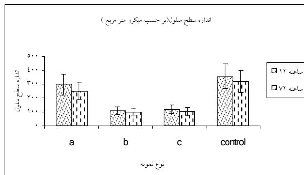
شکل ۶- اندازه سطح سلول ( $\mu m$ ) بعد از ۱۲ و ۷۲ ساعت  $\pm SD$  بر روی سیلیکون خام (a) و پلی‌اکریلیک اسید پیوند شده بر سیلیکون با شرایط پیوند: غلظت ۳۰٪- دما: ۶۵°C - زمان پیوند ۴ ساعت و فرکانس و پالس لیزری: ۱ و چگالی انرژی لیزر: (b)  $1/25 J/cm^2$  و (c)  $3 J/cm^2$
