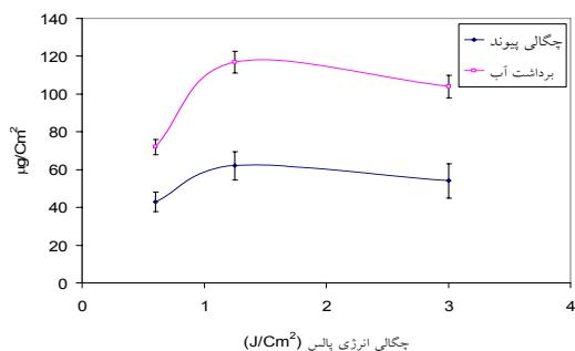
شکل ۱- اثر چگالی انرژی پالس بر چگالی پیوند و برداشت آب توسط سطح تعداد پالس: ۱۰، فرکانس پالس: ۱، غلظت: ۳۰٪، زمان اکسیژن زدایی: ۲۰ دقیقه، دما:  $65^{\circ}\text{C}$ ، زمان پیوند: ۴ ساعت
