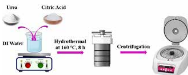
شکل ۲. طحورهای از مراحل ساخت نقاط کوانتومی گرافن آلاییده شده با نیتروژن
