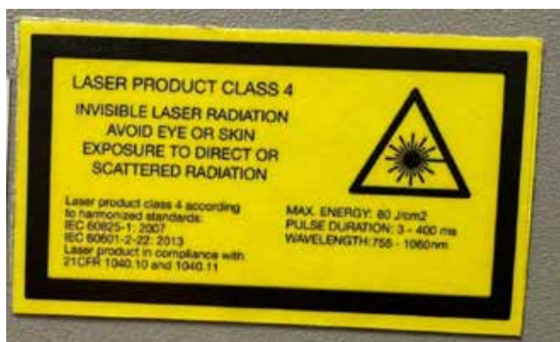
شکل ۱ - نمونه برچسب اطلاعات دستگاه و نشان‌دهنده استانداردهای آن
