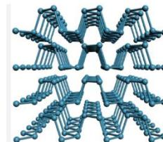
شکل 7- ساختار چند لایه فسفر سیاه [19].
