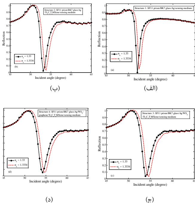
شکل 9- طیف بازتاب بر حسب زاویه فروپاشی برای (الف) ساختار 2 (ج) ساختار 3 و (د) ساختار 4 (ساختار پیشنهادی) [10].
