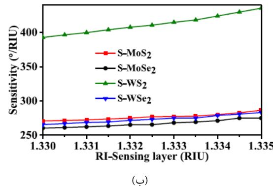
شکل 18- (الف) ساختار حسگر با فسفر سیاه و MXene و TMDCs (ب) تغییرات حساسیت نسبت به تغییرات ضریب شکست لایه حسگری به ازای مختلف [31].
