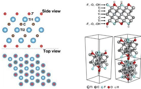
شکل 6- نمای کنار و بالا برای ساختار بلوری Ti<sub>3</sub>C<sub>2</sub>T<sub>x</sub> MXene. [50]
