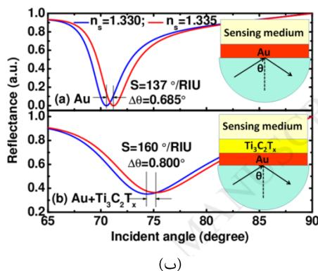
شکل 19- (الف) ساختار زیست‌حسگر SPR با استفاده از MXene (ب) تغییرات طیف بازتاب با زاویه نور فرودی [16].
