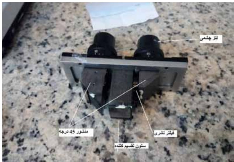
شکل ۴: ساختار هد میکروسکوپ (الف)، مسیر عبور نور منبع از هد (ب)
