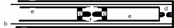
شکل ۱- شماتیکی از لیزر هوا (a) صفحه بالایی خازن (b) دی الکتریک (c) الکترودهای لیزر (d) اسپارک گپ (e) صفحات پایینی خازن (f) سیستم پیش تونش کننده uv
