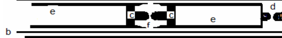
شکل ۱- شماتیکی از لیزر هوا (a) صفحه بالایی خازن (b) دی الکتریک (c) الکترودهای لیزر (d) اسپارک گپ (e) صفحات پایینی خازن (f) سیستم پیش تونش کننده uv
