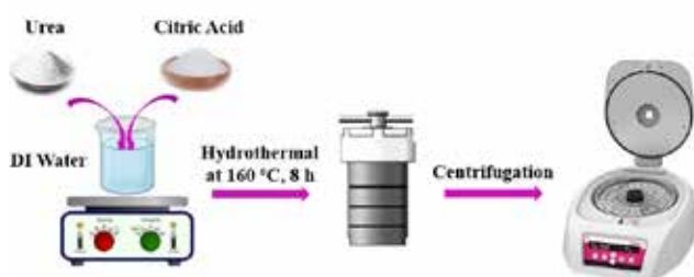
شکل ۲. طرحواره ای از مراحل ساخت نقاط کوانتومی گرافن آلاییده شده با نیتروژن
