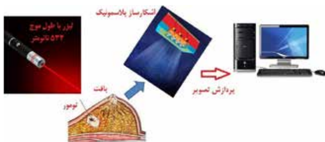
شکل ۱: شماتیک چیدمان آزمایشگاهی تشخیص سرطان پستان در فضای آزاد [۲۶]
