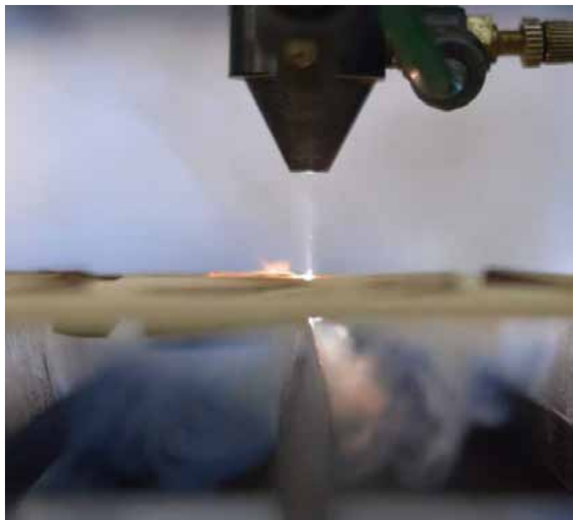
شکل ۴: تولید بخار فلزی به‌هنگام برش لیزری
