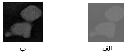
شکل ۸: الف) تصویر فیلتر میانه (ب) تصویر پس از اعمال ماتریس و سرکوب غیر حداکثری (تصاویر جهت مشاهده روشن شده‌اند)
